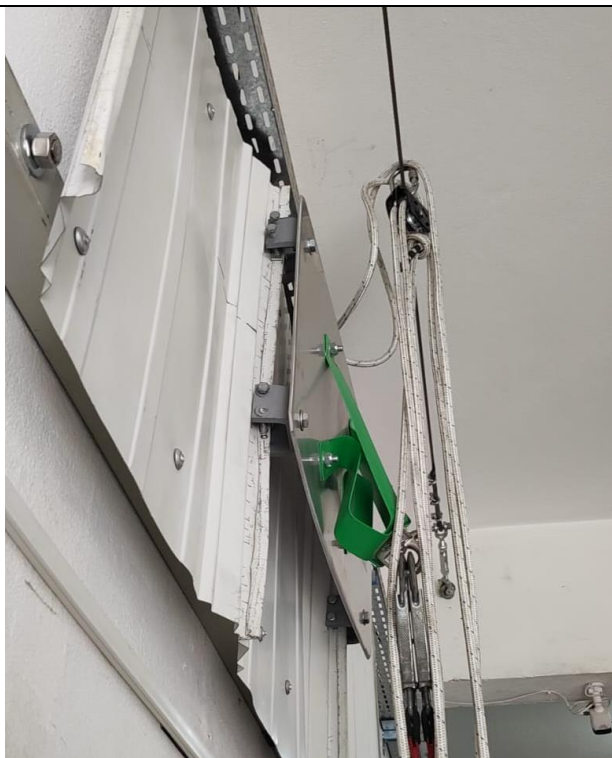
Dispositivo de ancoragem após o ensaio.
