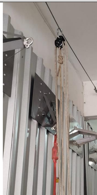
Dispositivo de ancoragem após o ensaio.
